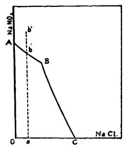
Se comprende que a 40° existirán infinitas soluciones según sean las cantidades relativas de nitrato y cloruro que pongamos en presencia de 100 gramos de agua; habrá una serie de soluciones saturadas únicamente por nitrato y no por cloruro y al revés, otra serie estará únicamente saturada por cloruro y no por nitrato. Todas ellas se pueden representar en una curva denominada esoterma; sea ABC la isoterma a 40° de temperatura.
